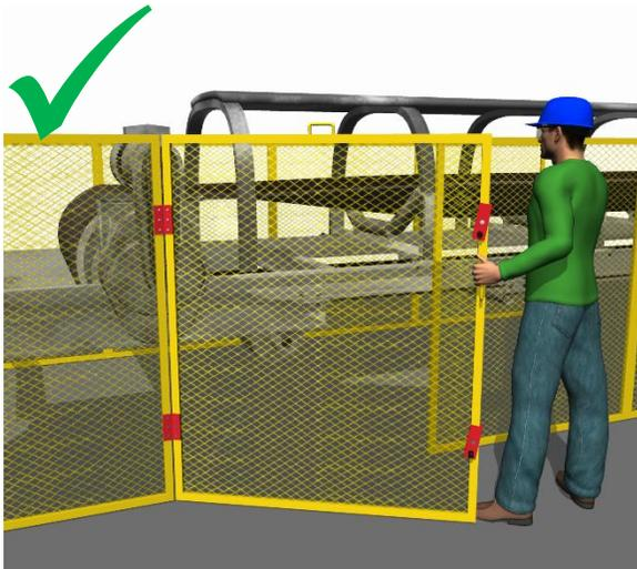
**La solución:** Diseñe barreras de protección de área que sean fáciles de manejar por un solo trabajador. Las barreras de protección se pueden montar en bisagras de puertas que permitan abrirlas fácilmente para el acceso.
