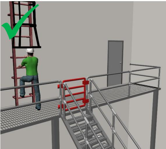
**La solución:** Asegúrese de que la parte superior de las escalerillas de acceso y las escaleras de mano estén desfasadas y equipadas con compuertas que se cierren solas y se abran hacia adentro para reducir la posibilidad de caída para los trabajadores.
