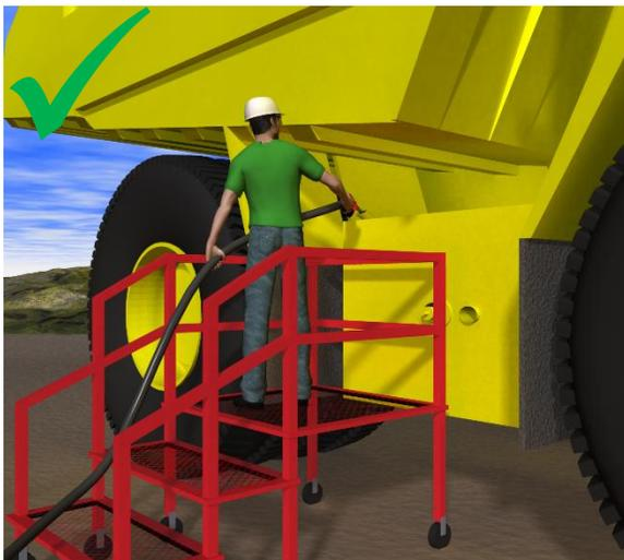
**La solución:** Agregue plataformas de acceso portátiles o escaleritas portátiles en zonas en las que se realiza la carga de combustible o la lubricación. Esto alienta a los trabajadores a usarlas mientras cargan combustible o lubrican los equipos móviles, como camiones de transporte pesado o volquetes, a la altura de trabajo ideal cerca del nivel de la cintura.
