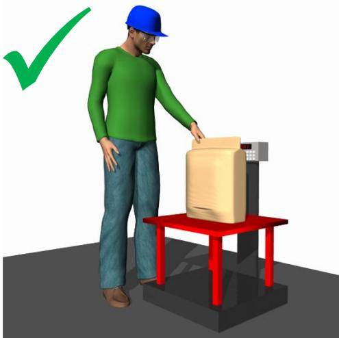
**La solución:** Ubique la base de la balanza de manera que las manos del trabajador estén cerca del nivel de la cintura cuando pese la bolsa. La balanza debe estar alineada con el lugar de llenado de la bolsa para eliminar la necesidad de cargar la bolsa hasta la balanza.
