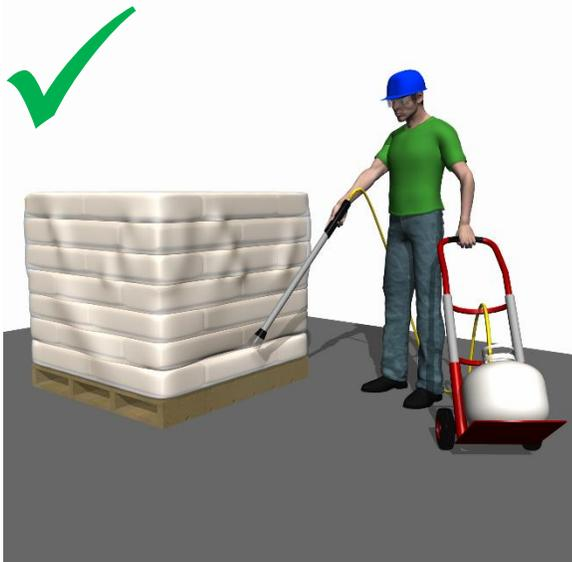
**La solución:** Suministre un carro sobre ruedas para transportar el tanque de propano. Con esto el trabajador jala del carro en lugar de cargar manualmente el tanque, el cual puede pesar más de 20 libras.
