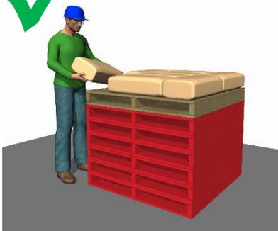
**Otra solución:** Si una mesa elevadora giratoria es demasiado costosa, apile paletas como soporte a fin de elevar la paleta más baja. Luego, paletice las bolsas hasta un punto intermedio antes de retirar la paleta de la pila y siga paletizando la paleta ya apilada sobre el piso.
