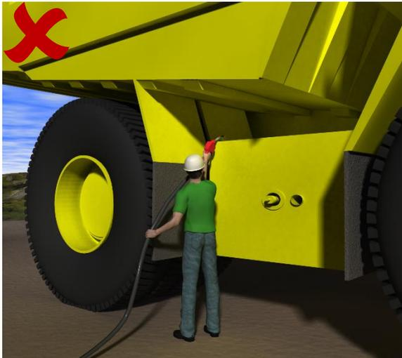
**El problema:** Las estaciones de carga de combustible para el equipo móvil suelen tener boquillas y puntos de carga de combustible ubicados a la altura de los hombros o por encima de ellos. De igual manera, la tapa del tanque de gasolina también puede estar ubicada a una altura por encima de los hombros. Estirarse por encima de la altura de los hombros puede aumentar el riesgo de lesión a los brazos y los hombros.
