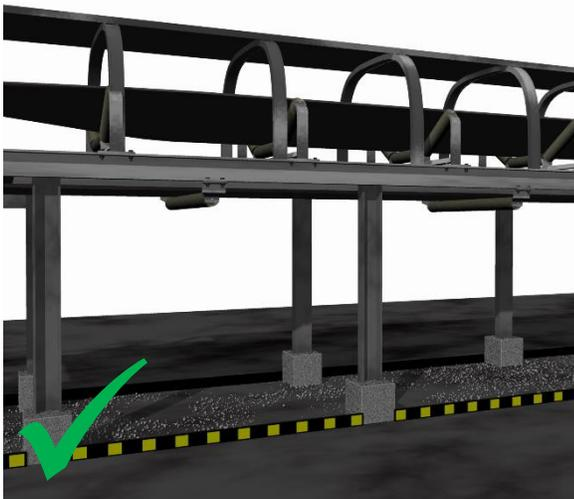
**La solución:** Agregue una barrera adyacente a las pasarelas para evitar que el derramamiento llegue a las pasarelas y cause resbalones. Por ejemplo, una placa saliente que se agrega a lo largo de una cinta transportadora y adyacente a la pasarela podría impedir que el derrame de la cinta transportadora llegue a la pasarela. Si la placa saliente es de color brillante y está claramente marcada, ayuda a prevenir los tropezones cuando se trabaja cerca o debajo de la cinta transportadora.
