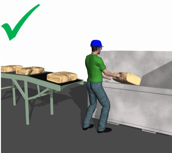
**La solución:** Provea un contenedor para la basura rediseñado con un reborde frontal más bajo para facilitar el levantamiento en la zona fuerte entre la cintura y los hombros. Esto reduce el esfuerzo que conlleva el trabajo a la altura de los hombros o por encima de ellos.
