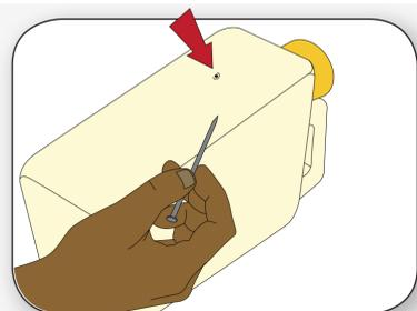
**1** Le « tippy tap » a besoin d'un trou pour laisser l'eau s'écouler. Le trou doit être fait sur le côté du bidon, du côté opposé à la poignée. Le trou doit faire la longueur d'un doigt en partant du haut du bidon. Repérez l'emplacement du trou et faire une marque.
