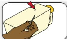
**1** Le « tippy tap » a besoin d'un trou pour laisser l'eau s'écouler. Le trou doit être fait sur le côté du bidon, du côté opposé à la poignée. Le trou doit faire la longueur d'un doigt en partant du haut du bidon. Trouvez l'emplacement du trou et faire une marque.
